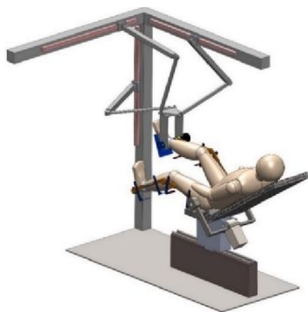
Рис. 7. Концептуальный проект системы реабилитации нижних конечностей
