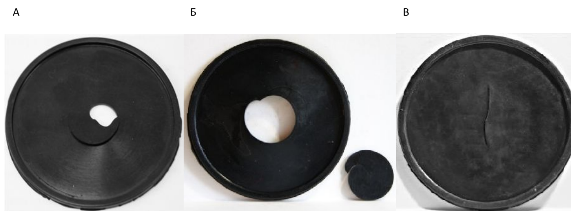
Рис. 4. Характер разрушения резин на основе каучуков СКИ-3 (А), СКД (Б) и СКМС-30АРК (В)
