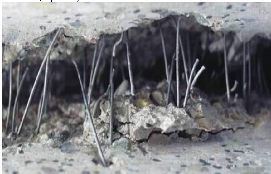
Рис. 3. Пример механизма разрушения фибронабрызбетона при превышении предела критической нагрузки, характерной для неармированных образцов (заметен процесс сдерживания фибры от критического «взрывного» отрыва для образцов с дисперсным армированием) – увеличение \times 100 (Источник: http://masters.donntu.org/2015/igg/barsuk/library/article2.htm )
